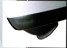
アストロ-Iの風の巻き込みを防ぐエアロフラップ。(ビルトインタイプ)
