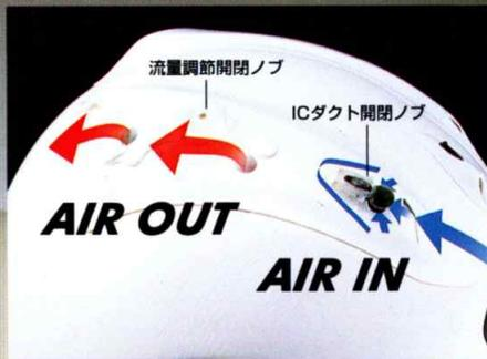
ヘルメット内部の換気効率を上げるためには、排気は不可欠です。従来の高い排気効率を維持するために、後部の角度を見直し、通気孔をすべて10mm径に拡大し、後方4孔により、従来と同一の排気効率を維持しました。さらに前方2孔は吸気専用とし、これによりヘルメット内部の換気効率を数10%引き上げました。
