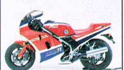
**NS 400 R:** Effekt hk DIN vid varv 72/9 500. Mom kpm DIN vid varv 5.0/8 500. Hjul 16" fram, 17" bak. Tank 19 l. Tjänstevekt 184 kg.
