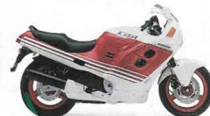
CBR 1000 F 4 cyl. vätskekyld 4 takt. 4 ventiler/cyl. 100 hk/9500 v. Torrsvikt 222 kg. C:a pris 68.900,-.
