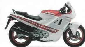
CBR 600 F 4 cyl. vätskekyld 4 takt. 4 ventiler/cyl. 85 hk/11000 v. Torrsvikt 182 kg. C:a pris 49.900,-.
