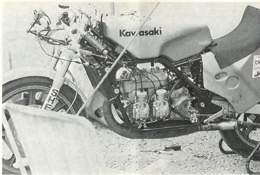
Deutlich erkennbar die hintereinanderliegenden Zylinder des Kawasaki-Motors mit seitlich am Kurbelgehäuse angeflanschten Vergaser. Einlaß drehschiebergesteuert.
