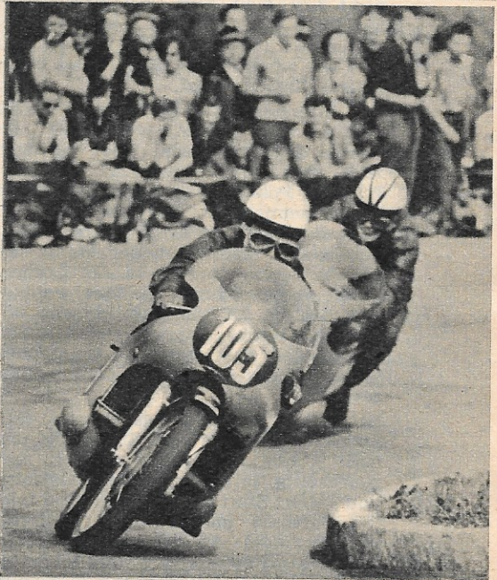
Eine der beiden 50-ccm-MZ-Maschinen, die in Schleiz vorgeführt wurden. Zugegeben sind 13 PS und 130 km/h Spitze
