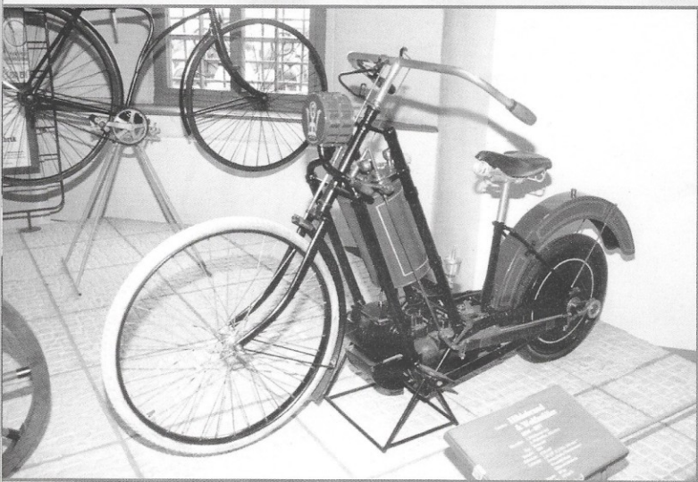
Die Hildebrand & Wolfmüller von 1894 ist das erste patentierte „motorisierte Einspurfahrzeug“ oder kurz: Motorrad
