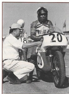
Mike Hailwood vor dem 200 Meilen-Rennen von Daytona 1971: An seiner Renn-Rocket 3 ist auch auf dem Vorderderrad ein Dunlop KR 73 montiert - eigentlich ein reiner Hinterreifen. Doch wegen der hohen Belastung des Vorderreifens auf dem schnellen Kurs, sowohl in der Steilwandkurve als auch beim Bremsen, schien der KR 73 auf der schweren BSA mehr Sicherheitsreserven zu haben
